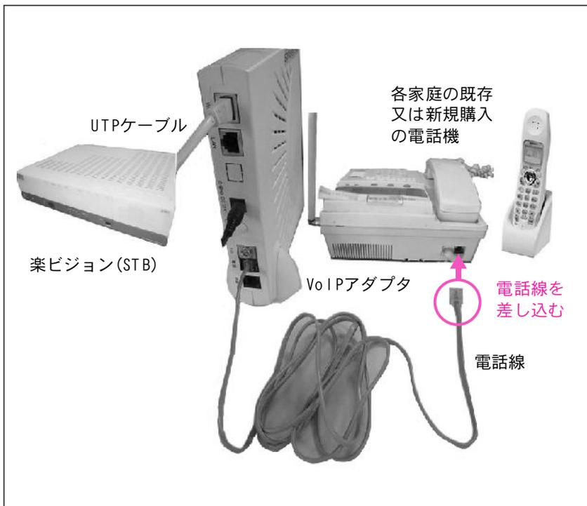
(図1) 当初IP電話機以外の電話機でIP電話を利用する場合の接続構成
