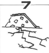
激震＝家屋の倒壊多発。山崩れ、地割れで道路寸断
